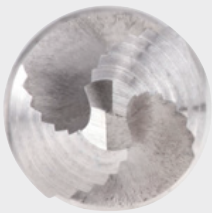
Geometría de punta de mecha escalonada
