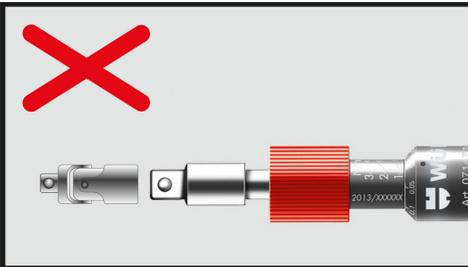
Para evitar que se produzca una "carga lateral" con lecturas de par inexactas mantenga el destornillador dinámico 1/4" en posición perpendicular con respecto al plano de uso.
